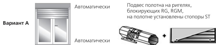
Установка конечных положений происходит автоматически при достижении полотном роллеты упоров. Нижнее конечное положение устанавливается вследствие жесткой подвески полотна на блокирующих ригелях (упор в подоконник, нижнее обрамление), верхнее – за счет стопоров ST (упор в короб роллеты).
