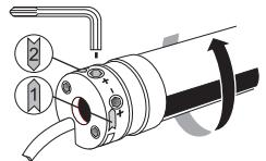
Поворот регулировочного винта в направлении «+» (плюс) увеличивает диапазон вращения вала электропривода в выбранном направлении. Поворот регулировочного винта в направлении «-» (минус) уменьшает диапазон вращения вала электропривода.
