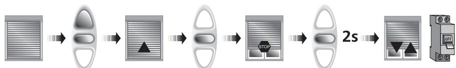
Программирование привода завершено. Полотно роллеты будет останавливаться по достижении установленного верхнего конечного положения. В нижнем положении полотно роллеты будет останавливаться при упоре в подоконник (нижнее обрамление).
