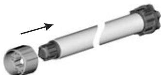
3. Установить привод в октогональный вал таким образом, чтобы адаптер полностью вошёл в вал, обращая внимание на совпадение пазов адаптера и замка октогонального вала. Крепление адаптера к валу произвести самонарезающим винтом или заклепкой d=4 мм.
