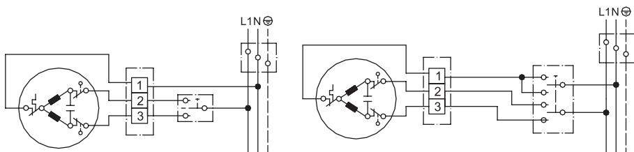
При необходимости управления несколькими приводами одним выключателем, для каждого привода должна быть предусмотрена отдельная контактная группа.
