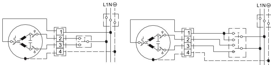
При необходимости управления несколькими приводами одним выключателем, для каждого привода должна быть предусмотрена отдельная контактная группа. Параллельное подключение запрещено!
