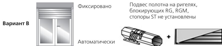
Установка нижнего конечного положения роллетного полотна происходит автоматически. Верхнее конечное положение полотна фиксируется в выбранной точке при программировании.
