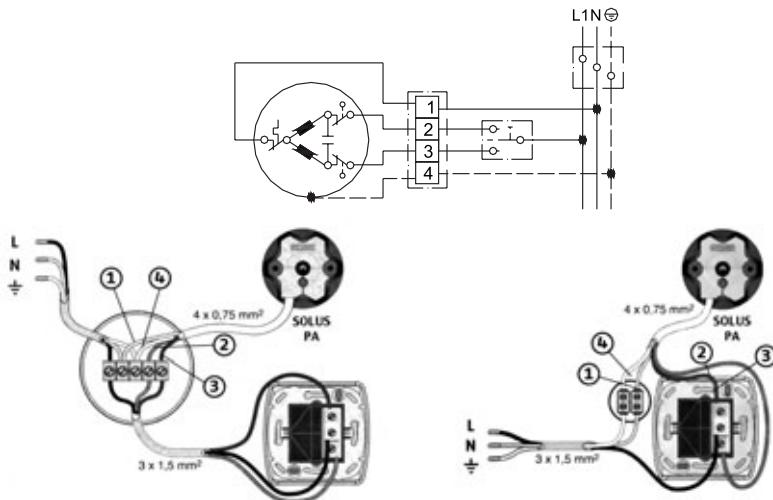
Разрешается использовать только приборы управления с механической или электрической блокировкой от одновременного включения противоположных направлений вращения вала привода (другими словами, применительно к роллете, одновременная подача команды на ПОДЪЕМ и ОПУСКАНИЕ полотна должна быть исключена). Одновременная подача команд приводит к короткому замыканию. Ток короткого замыкания достаточно велик, что обуславливает выход из строя привода.
