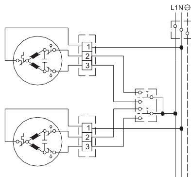
Разрешается использовать только приборы управления с механической или электрической блокировкой от одновременного включения противоположных направлений вращения вала привода (другими словами, применительно к роллете, одновременная подача команды на ПОДЪЕМ и ОПУСКАНИЕ полотна должна быть исключена). Одновременная подача команд приводит к короткому замыканию. Ток короткого замыкания достаточно велик, что обуславливает выход из строя привода.
