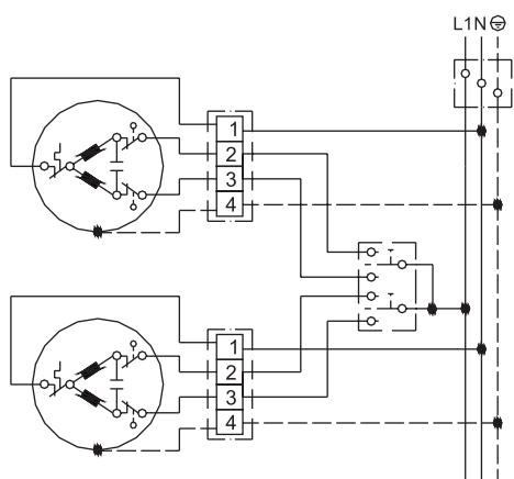
Разрешается использовать только приборы управления с механической или электрической блокировкой от одновременного включения противоположных направлений вращения вала привода (другими словами, применительно к роллете, одновременная подача команды на ПОДЪЕМ и ОПУСКАНИЕ полотна должна быть исключена). Иначе происходит короткое замыкание, ток которого достаточно велик, и приводит к выходу электропривода из строя.
