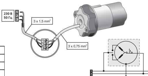
Во избежание попадания воды в привод, рекомендуется прокладывать кабель с образованием петли, направленной вниз.
