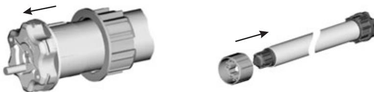
3. Установить привод в октогональный вал таким образом, чтобы адаптер полностью вошёл в вал, обращая внимание на совпадение пазов адаптера и замка октогонального вала. Крепление адаптера к валу произвести самонарезающим винтом или заклепкой d=4 мм.
