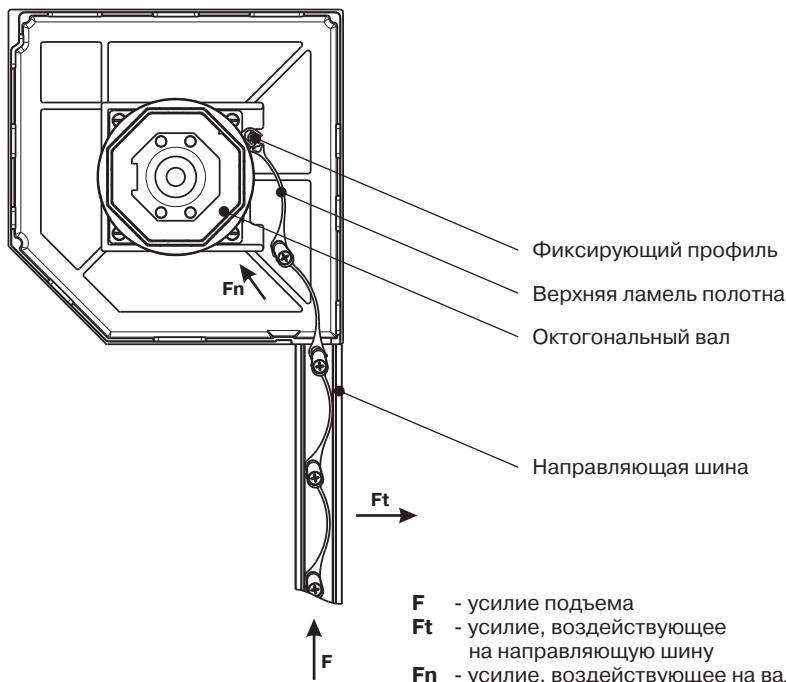
**Рис.3.** Схема усилий препятствующих подъему
