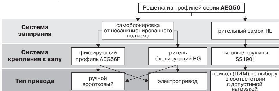
Методика расчета геометрических размеров роллеты в целом и ее деталей, получаемых нарезкой длинномерных заготовок, является стандартной вне зависимости от варианта комплектации, в том числе и системы запирания. Корректировки требует только расчет необходимой высоты полотна роллеты (см. п. 7 «Расчет геометрических размеров» настоящего руководства).
