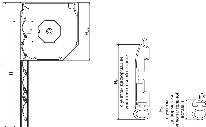
3. Определить требуемую высоту полотна  $H_3$  без концевого профиля ESR/ES и уплотнительной вставки IS9 по формуле:
