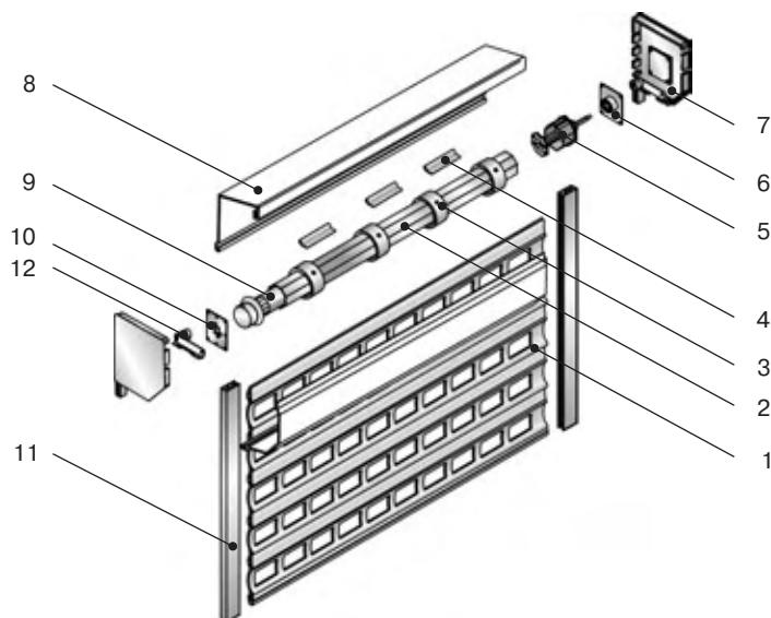
**Рис.2.** Комплектация полотна решетки из комбинации решеточных профилей AEG56 и усиливающих профилей AEG30/S с использованием фиксирующего профиля AEG56F (рекомендуемая ширина проема – от 3,0 до 4,5 метра)
